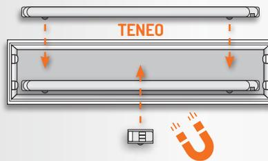
Mit Hilfe der Magnetbefestigungen den LED Sanierungseinsatz TENE0 und den vorkonfigurierten Anschluss-Klemmblock am Bestandsgehäuse positionieren, anschließend anschrauben.
