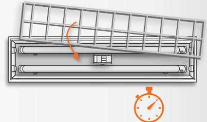
Die Einspeisung durch die Zugentlastung des Anschluss-Klemmblock führen und die LED Sanierungseinsätze miteinander verdrahten. Das bestehende Raster wieder einsetzen. Fertig!
