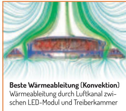
**Beste Wärmeableitung (Konvektion)**
