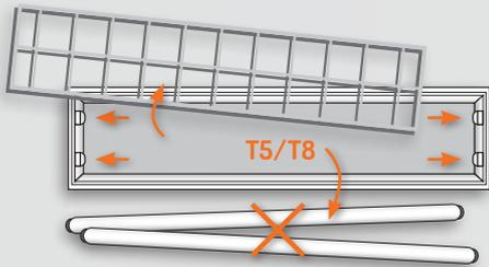
Für spannungsfreien Zustand an den Leuchtklemmen sorgen. Den Rastereinsatz vom Bestandsgehäuse abziehen. Die alten T5- oder T8-Leuchtstoffröhren lösen und entsorgen.
