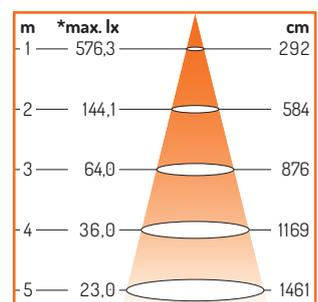
\* Die Lux-Angabe entspricht lediglich einer theoretischen Angabe einer Einzelluchte. Durch eine praxiserichtete Lichtberechnung mit einer Mehrzahl von Leuchten wird dieser Wert um ein Vielfaches größer.
