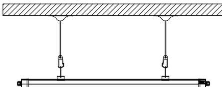
2 **Optional** abgehängte Deckenmontage: Verschrauben Sie die Seilaufhängung an der Decke. Haken Sie den Draht der Halterung ein und fixieren Sie die Leuchte innerhalb der Clips.
